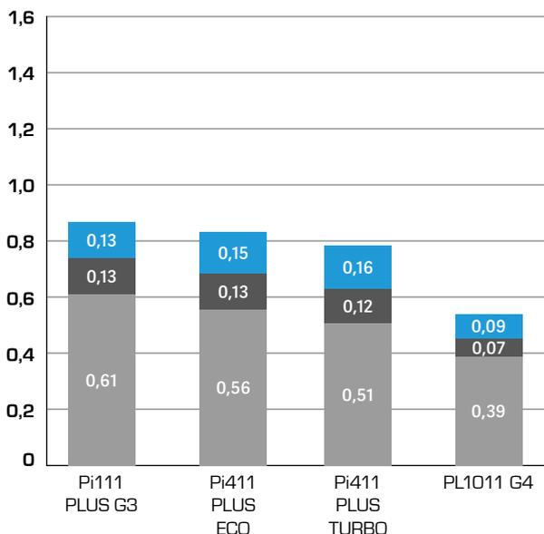
Diagramm links visualisiert die Aufteilung der Kosten pro Werkzeug in verschiedenen PLATIT PVD-Beschichtungsanlagen. Die Kosten pro Werkzeug sinken bei grossen PVD-Beschichtungsanlagen aufgrund von Skaleneffekten deutlich.
