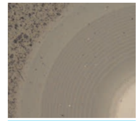
Calo: nACRo CrN adhesion layer AlCrN core layer AlCrSiN top layer
