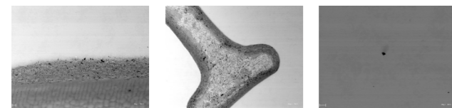
Rückstände von Gravuren (Oxide) Rückstände vom Polieren Inhomogenität des Materials (Poren oder Karbide)
