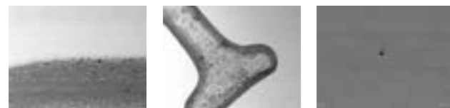
Rückstände von Gravuren (Oxide) Rückstände vom Polieren Inhomogenität des Materials (Poren oder Karbide)
