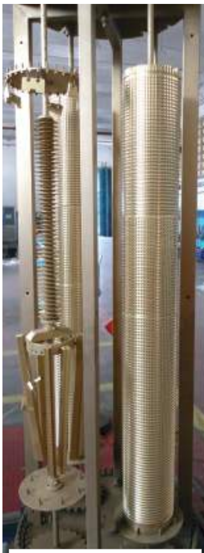
Bild 1: Beschichtete großen Räumnadeln.
