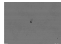
Inhomogenität des Materials (Poren oder Karbide)
