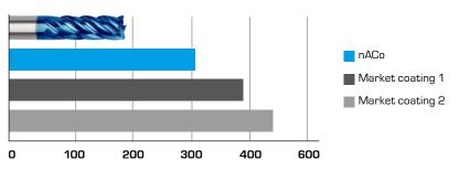
Werkzeug: Vollhartmetall-Schaftfräser; D4; z = 4; Schnittlänge = 6 mm Werkstückmaterial: SUS316
